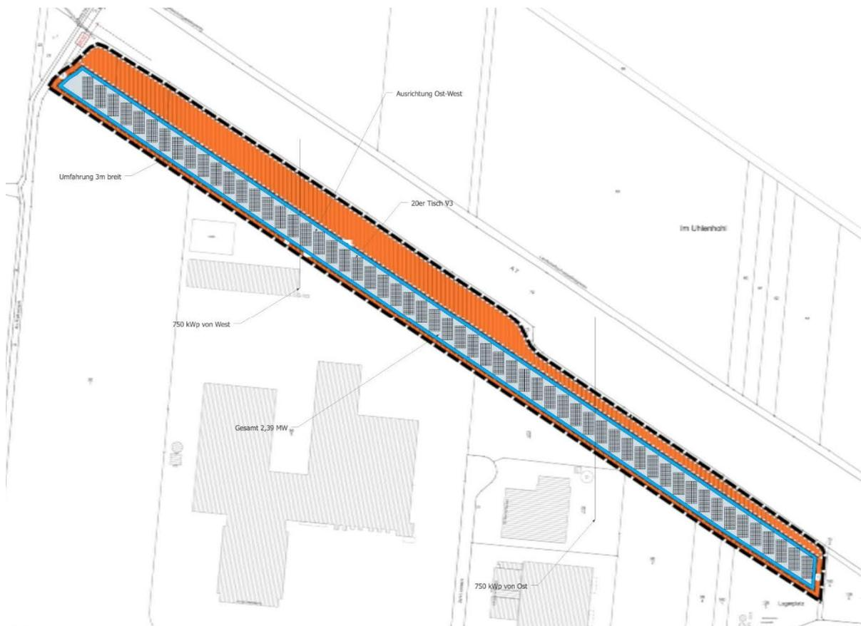
Abb. 12: Skizze Stellplan der PV-Anlagen (Quelle: Versorgungsbetriebe Hann. Münden, unmaßstäbliche Verkleinerung)
